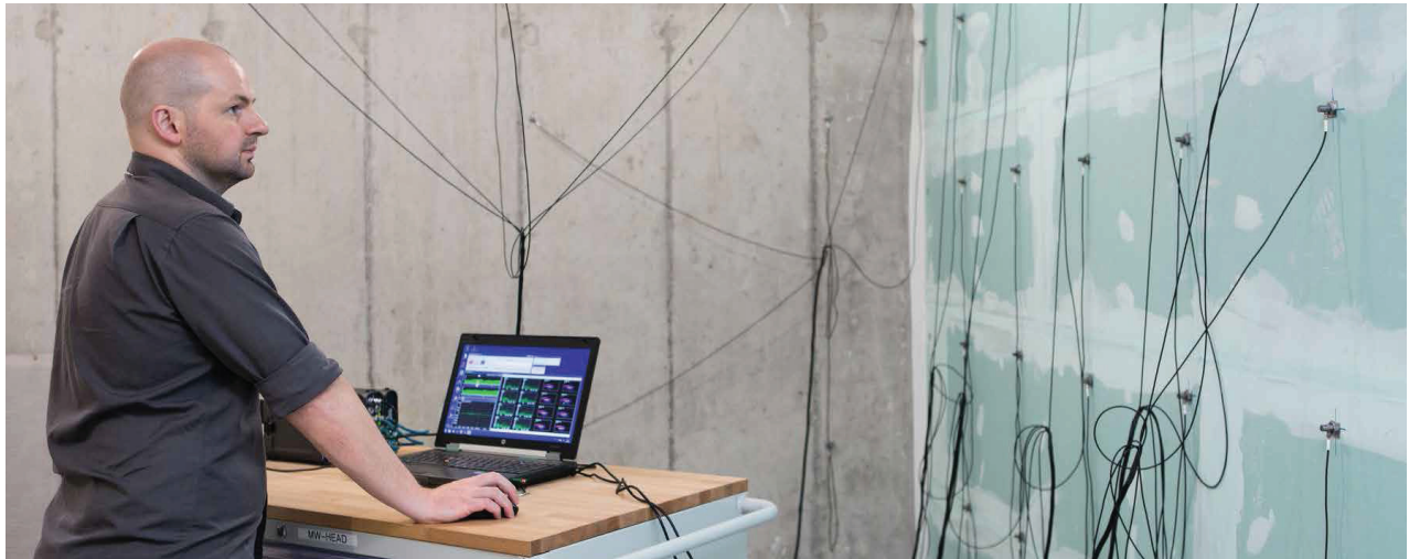
Samuel Pasteur, Akustikspezialist bei Geberit, misst mittels Beschleunigungssensoren die Schallübertragung von einer Unterputzinstallation auf einen benachbarten Raum.
